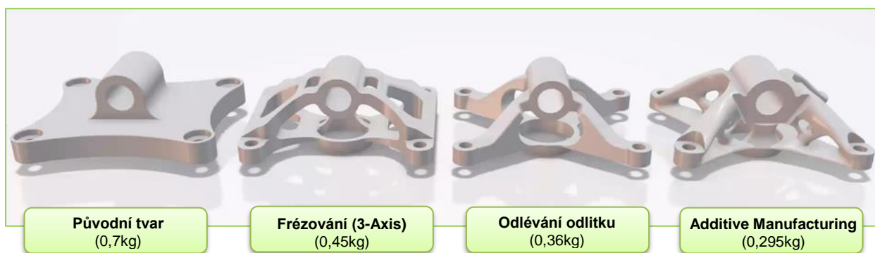
Porovnání originálního tvaru výrobku s optimalizovanými tvary pro frézování, odlévání a AM (additive manufacturing).
